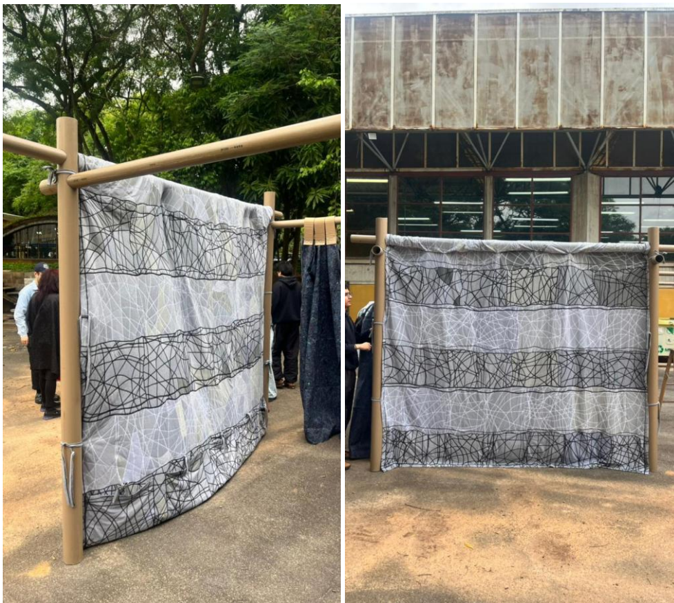
Figuras 5 e 6: Montagem do projeto PPS4 e teste da superfície têxtil confeccionada no workshop , na Seção Técnica de Modelos, Ensaios e Experimentações Construtivas da FAUUSP. Fonte: Arquivo dos autores, 2025.
